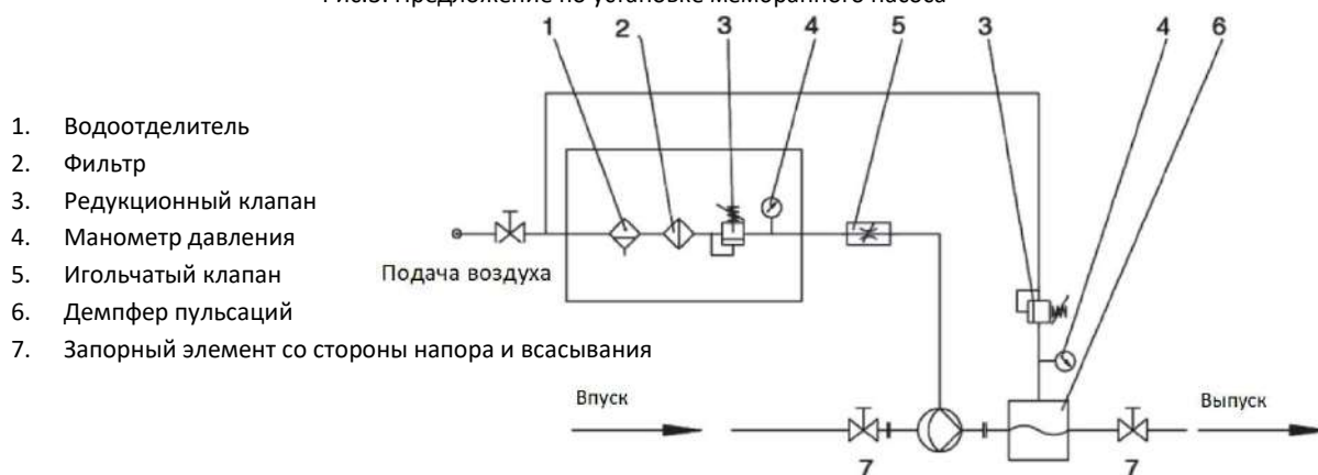
Рис.3: Предложение по установке мембранного насоса
